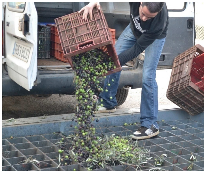
Descarga de las cajas en la tolva de recepción de la almazara
