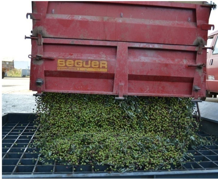
Descarga del remolque en la tolva de recepción de la almazara
