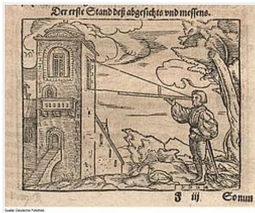
Uso de una vara de Jacob, según un grabado de 1536.
