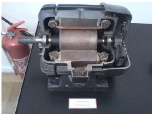
Figura 33. Sección transversal de un motor eléctrico Tesla finales del siglo XIX. Museo Belgrado.
