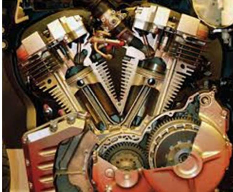
*Figura 17. Sección de un motor en V de cuatro tiempos.*
