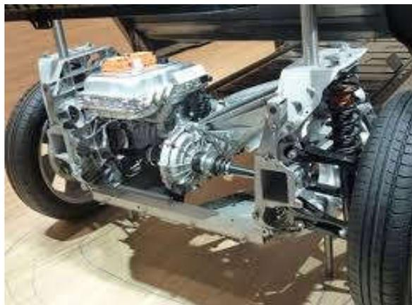
Figura 36. Motor eléctrico del BMW i3.
