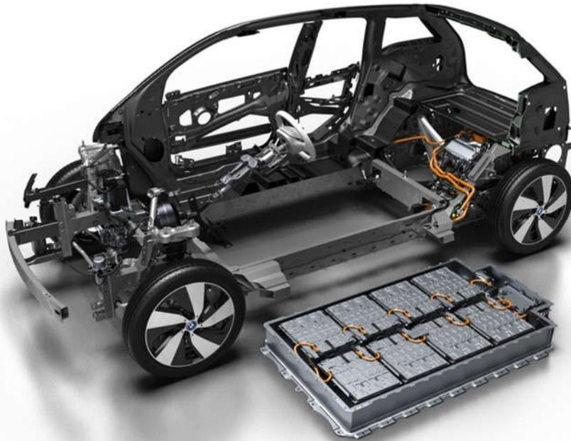
Figura 66. Las baterías en el coche eléctrico Imagen procedente de motorpasion.
