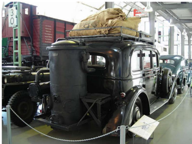
Figura 24. Generador de gasógeno acoplado a un coche Adler. Observar la provisión de ¿carbón? en el techo.
