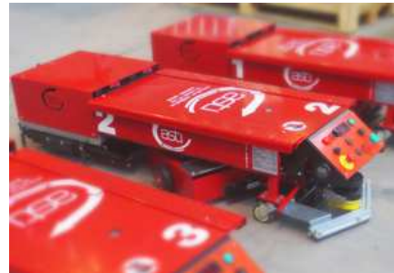
Figura 7 AGV de AST, modelo EasyBots para el transporte flexible de materiales. Este tipo de vehículos está caracterizado por la sencillez tanto de instalación como de uso. Esta herramienta es la solución perfecta para la automatización flexible en líneas de ensamblaje.
