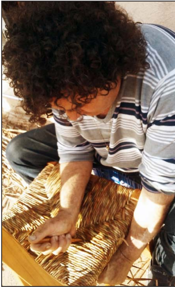
Ensamblando el ultimo cordón hacia la izquierda
