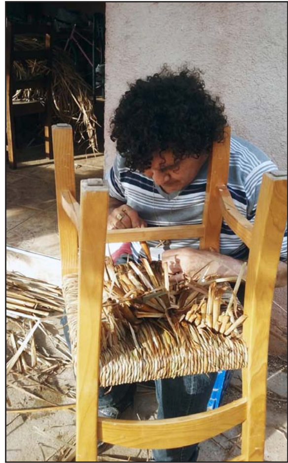
Anea sobrante embutiéndola, ayudado con el punzón, en la parte inferior del asiento
