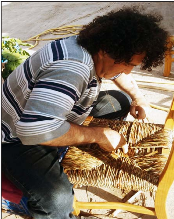
Cordón de anea ajustándolo y encajándolo hacia la izquierda
