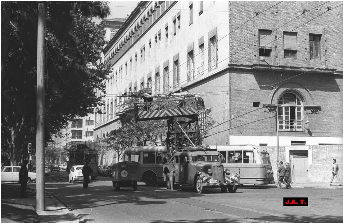
Cruza un trolebús de la línea 13. Dos operarios retiran de la línea aérea los troles, una vez el vehículo ha tomado impulso. Otro operario ha detenido al motocarro para que no se cruce en el camino del trolebús.
