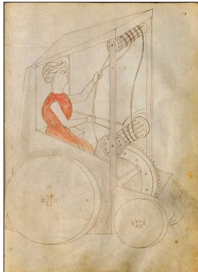
Imagen 3: Vehículo de cuatro ruedas, que utiliza una cuerda sin fin.
