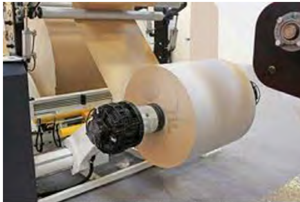
Rebobinadora de papel Kraft Obsérvese al fondo la bobina "madre" con las orillas sin "desbarbar" (en basto tal y como se bobina en la pope).
